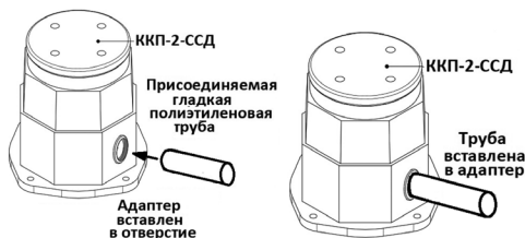
Рисунок 18 – Ввод гладкой трубы в адаптер
